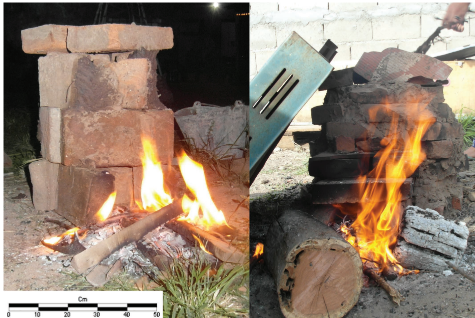
Figura 3: Estructuras de combustión utilizadas durante la experimentación.
